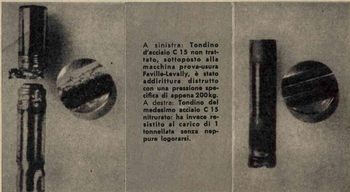
**A sinistra: Tondino d'acciaio C 15 non trattato, sottoposto alla macchina prova-usura Faville-Levally, è stato addirittura distrutto con una pressione specifica di appena 200kg. A destra: Tondino del medesimo acciaio C 15 niturato: ha invece resistito al carico di 1 tonnellata senza neppure logorarsi.**
