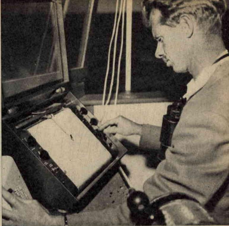
A sinistra: Il golfo Persico abbonda di isolette basse e di scogliere coralline. Nella nuova sistemazione della zona, queste vengono tutte segnalate con apposite boe luminose. A destra: I segnali radio del Sistema Decca, una volta ricevuti dalla nave vengono automaticamente convertiti in segnali leggibili su quadrante, che riportati su speciale carta, danno senza far calcoli la posizione della nave.
