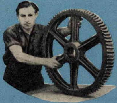
**Nella costruzione di autoveicoli e nella meccanica di precisione si nitrurano: assi di innesto, bulloni, giunti cardanici, scatole differenziale, perni fusi a snodo, ingranaggi vari, viti, dadi, organi e pezzi di macchine da scrivere, da calcolo, da cucire, ecc.**
