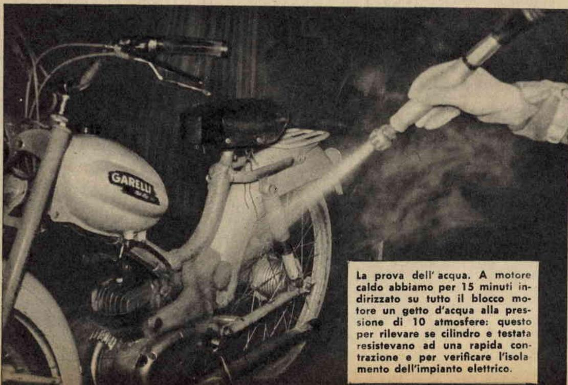
La prova dell'acqua. A motore caldo abbiamo per 15 minuti indirizzato su tutto il blocco motore un getto d'acqua alla pressione di 10 atmosfere: questo per rilevare se cilindro e testata resistevano ad una rapida contrazione e per verificare l'isolamento dell'impianto elettrico.
